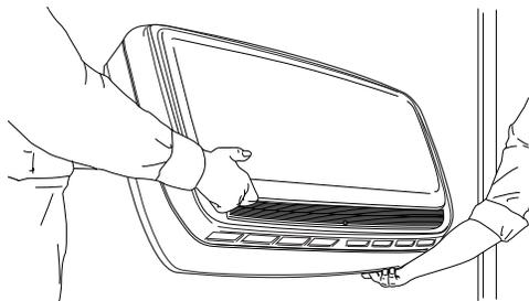
Con cuidado, incline la máquina hasta que quede apoyada verticalmente, sostenida por el soporte del lado de la pared, y el pestillo de extracción se haya trabado. Es posible que sea necesario deslizar suavemente la máquina hacia la izquierda o hacia la derecha para asegurarse de que el pestillo esté completamente trabado. Se escuchará un suave clic cuando el pestillo se trabe.
