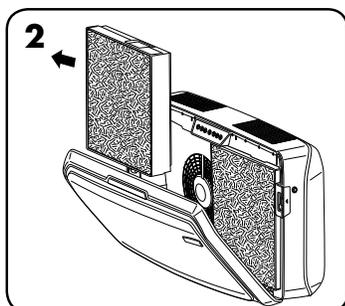
Abra el panel frontal presionando los pestillos en ambos lados de la unidad. Deje que el panel se abra completamente. Retire el o los filtros que se reemplazarán.
