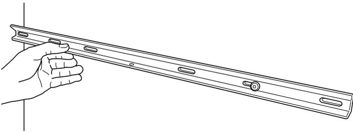
Une fois le support mural monté, demandez à une autre personne de vous aider à soulever le purificateur d'air et préparez-vous à l'installer sur le support mural. Soulevez l'appareil de manière à positionner le support de l'appareil par-dessus le support mural. Inclinez l'appareil à environ 45 degrés et abaissez-le jusqu'à ce que le support de l'appareil repose sur le support mural.
