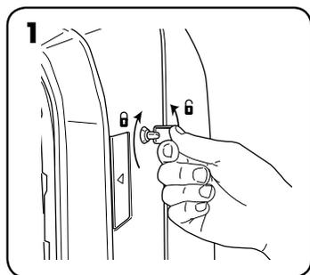
1 Déverrouiller le panneau d'accès : pour déverrouiller, insérer la clé fournie et la faire tourner d'un quart de tour dans le sens antihoraire.
