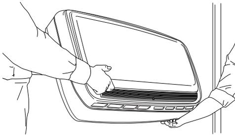
Redressez délicatement l'appareil jusqu'à ce qu'il repose verticalement, soutenu par le support mural, et que le loquet de retrait se soit enclenché. Il est possible que l'appareil doive être légèrement glissé vers la gauche ou vers la droite pour s'assurer que le loquet est complètement enclenché. Un petit clic se fera entendre lorsque le loquet s'enclenchera.
