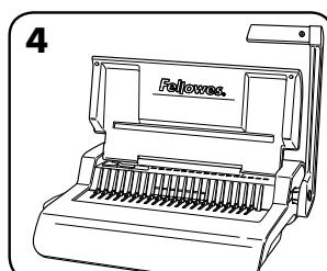
4. Coloque la manija de perforación en la posición vertical.
