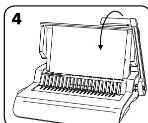
4. Perfore hojas a modo de prueba para verificar la configuración de la guía de bordes.
