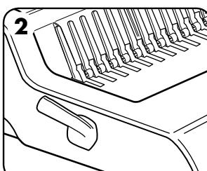
2. Insérez le peigne de plastique dans le mécanisme.
