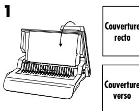
1. Perforez d'abord les couvertures avant et arrière.
