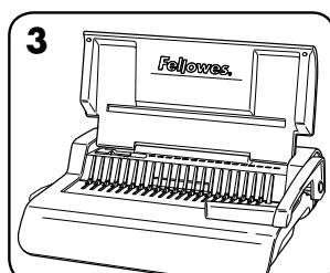
3. Levante la tapa. Asegúrese de que la palanca de apertura del peine esté colocada hacia atrás.
