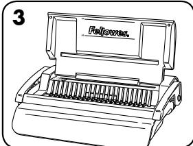
3. Levante la tapa. Asegúrese de que la palanca de apertura del peine esté colocada hacia atrás.
