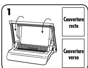
1. Assurez-vous que le guide de bordure soit configuré conformément à la taille du document. Perforez d'abord les couvertures avant et arrière.
