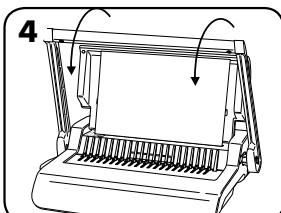
4. Perfore hojas a modo de prueba para verificar la configuración de la guía de bordes.
